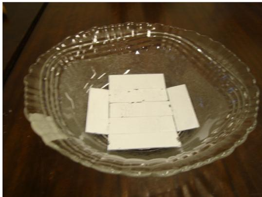
**Figura 14 - Foto dos catalisadores imobilizados nas lâminas de vidro e dispostos no recipiente reacional.**
