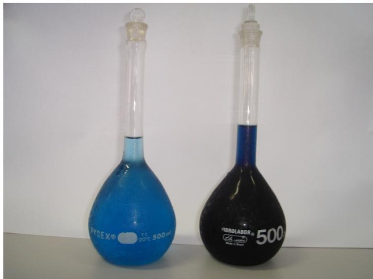
**Figura 15 – Foto da solução de corante Azul Reativo 222 à concentração de 10 mg.L<sup>-1</sup> e 100 mg.L<sup>-1</sup>**
