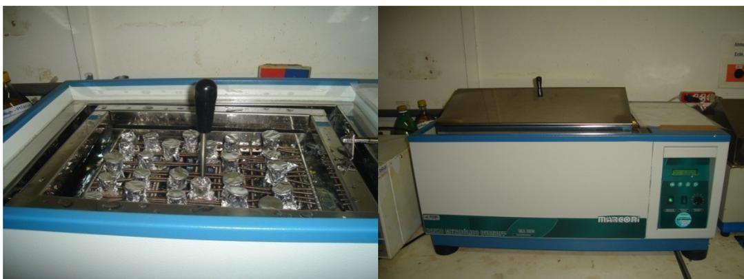
**Figura 16 – Fotos do banho térmico – Laboratório de Catálise do DEQ**
