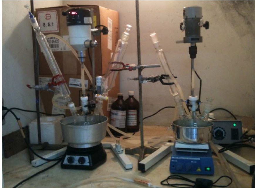
Figura 7. Aparato utilizado na preparação do catalisador sol-gel.
