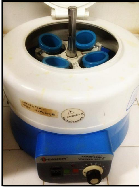
Figura 5: Rotor e recipientes para amostras da centrífuga Excelsa Baby II 206-R.
