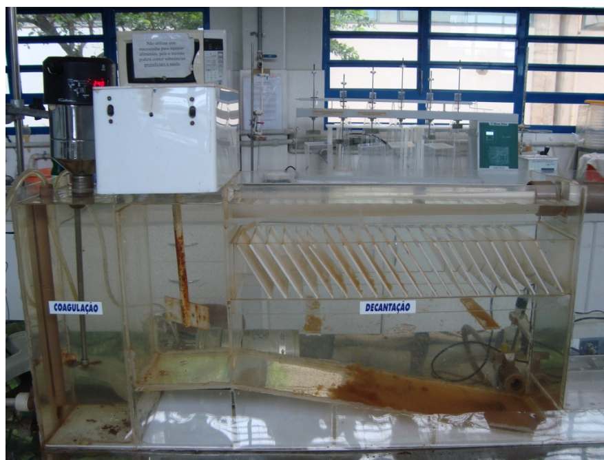
Figura 4.2 - Estação de tratamento de água piloto.
