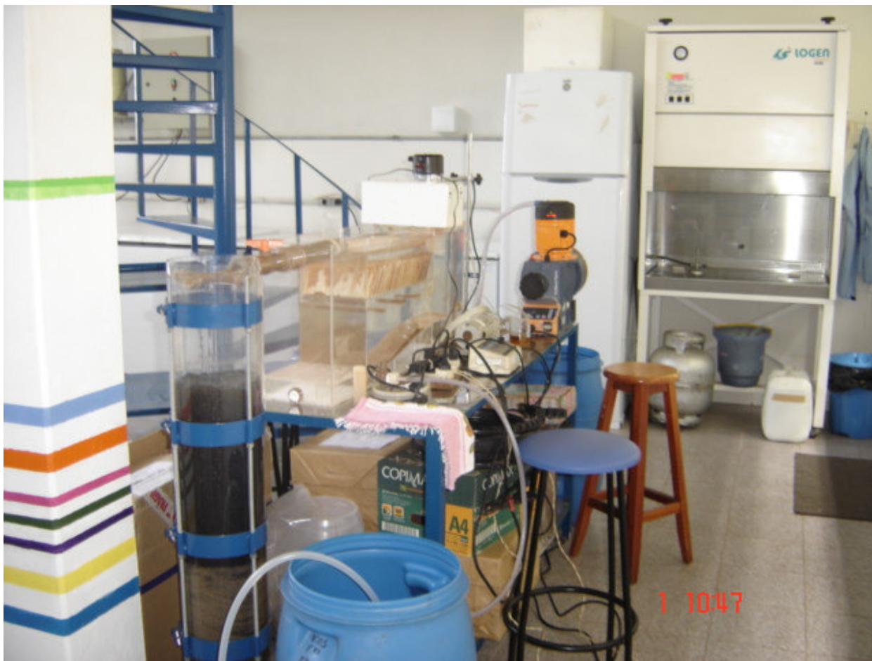
Figura 4.3 - Estação de tratamento de água piloto
