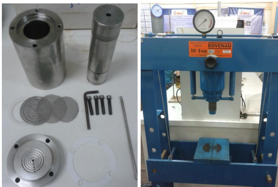
Figura 14 – Célula extratora (a) e prensa hidráulica (b) utilizada no processo de extração mecânica do óleo da semente de moringa.
