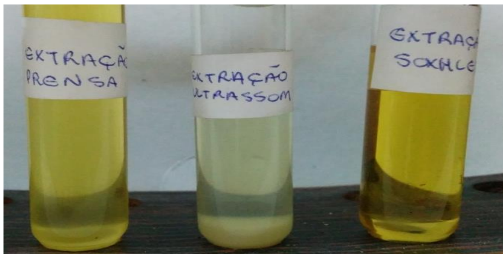
Figura 38 – Óleos de moringa extraídos por meio dos métodos de prensa, ultrassom e Soxhlet.
