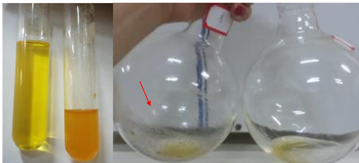
Figura 24 - (a) Óleo extraído com solvente etanol (esquerda) e hexano (direita); (b) Seta vermelha indicando a presença de incrustações na extração por isopropanol (esquerda) quando comparado com a extração com hexano (direita).
