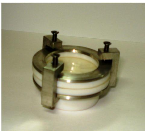
**Figura 27** – Célula utilizada nos testes de permeabilidade ao vapor de água.
