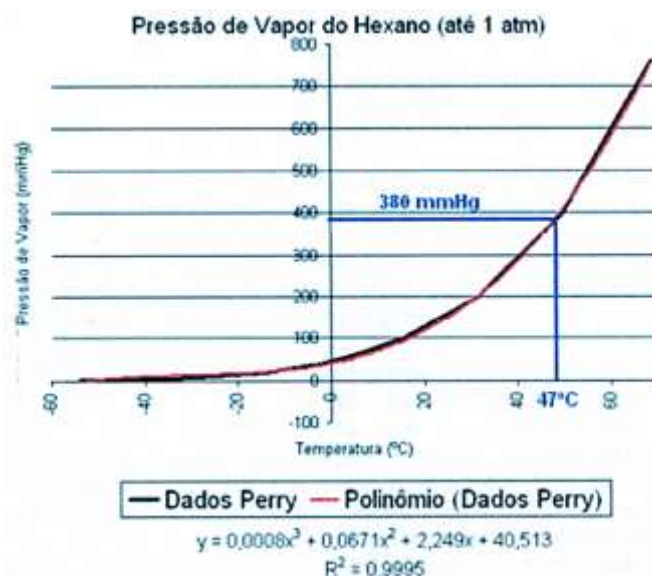
Figura 2.12 Curva de pressão de vapor do hexano. (Adaptado de PERRY e CHILTON, 1980).
