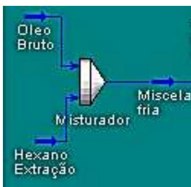
Figura 4.1 integrantes da corrente de miscela hipotética de óleo de soja e hexano no HYSYS
