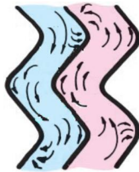
Figura 1.5: Escoamento turbulento nos canais de um TCP (Taco, 2011).
