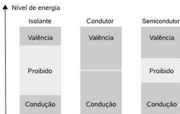
Figura 13: Banda de valência, banda proibida ( bandgap ) e banda de condução de: isolantes, condutores e semicondutores.
