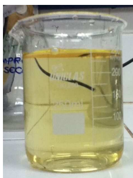
Figura 4.20 - Solução de Fe/EDTA 0,2 mol/L desativada e filtrada.
