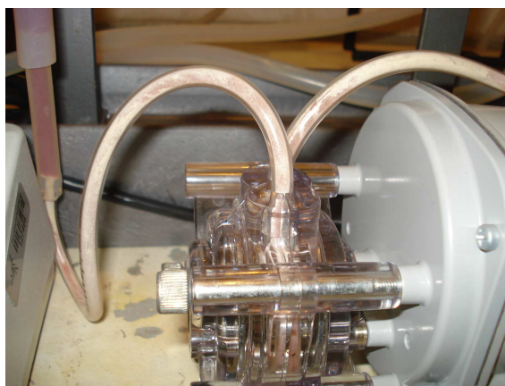
Figura 4.10 - Mangueira de silicone acoplada à bomba peristáltica para transportar Fe/EDTA no aparato experimental, totalmente preenchida com partículas de enxofre.
