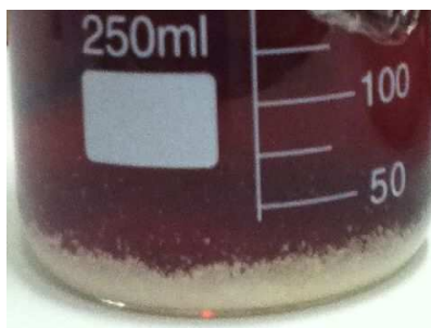
Figura 4.2 - Teste qualitativo da remoção de H_2S pela formação de enxofre elementar.
