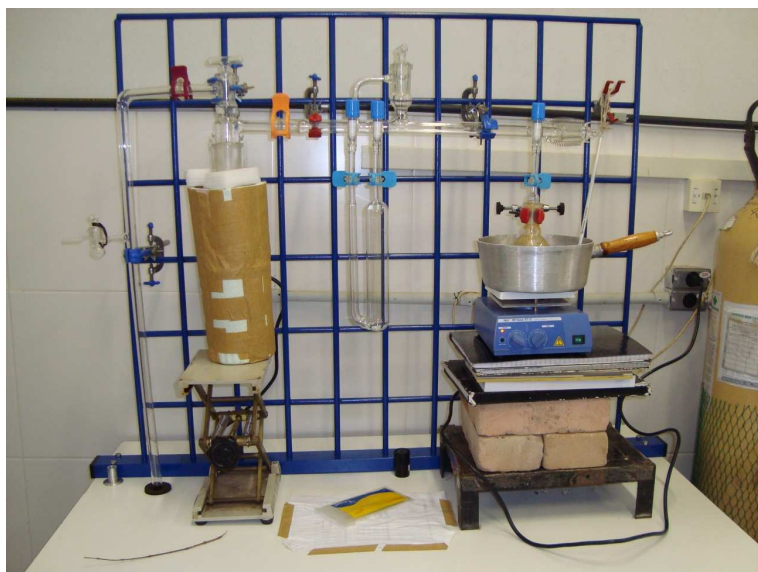
Figura 3.7 - Linha de alto-vácuo para secagem do sal.
