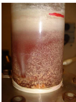
Figura 4.4 - Formação de enxofre elementar na coluna de absorção química.
