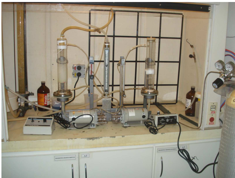
Figura 3.2 - Foto do sistema experimental utilizado nos ensaios para remoção de \text{H}_2\text{S} e \text{CO}_2 .
