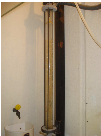
Figura 3.3 - Coluna de absorção com recheio empacotada com Raschig de vidro.
