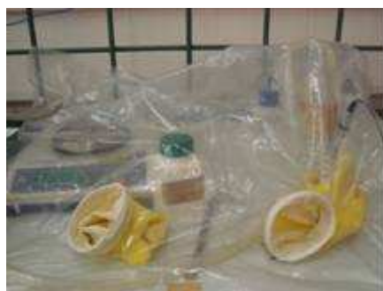
Figura 3.9 - “Glove-bag” para complexação do Fe/EDTA em atmosfera inerte.
