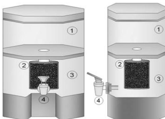
Figura 9 – Representação esquemática do sistema de purificação de água para usos doméstico.
