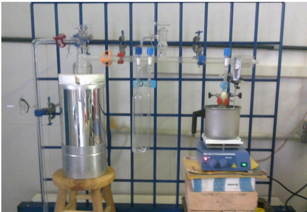
**Figura 6** – Linha de vácuo utilizada na secagem dos catalisadores.
