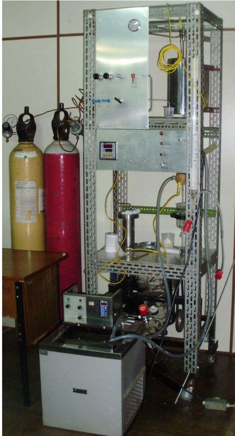
**Figura 8** – Módulo experimental utilizado na avaliação catalítica.
