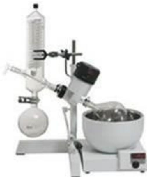
**Figura 5** – Esquema do rota-evaporador.
