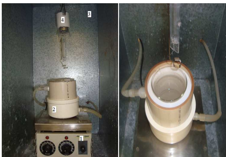
Figura 4.2 – Reator Fotocatalítico. (1) Agitador Magnético; (2) Circulação de água; (3) Caixa Isolante de Radiação; (4) Lâmpada de Vapor de Mercúrio.
