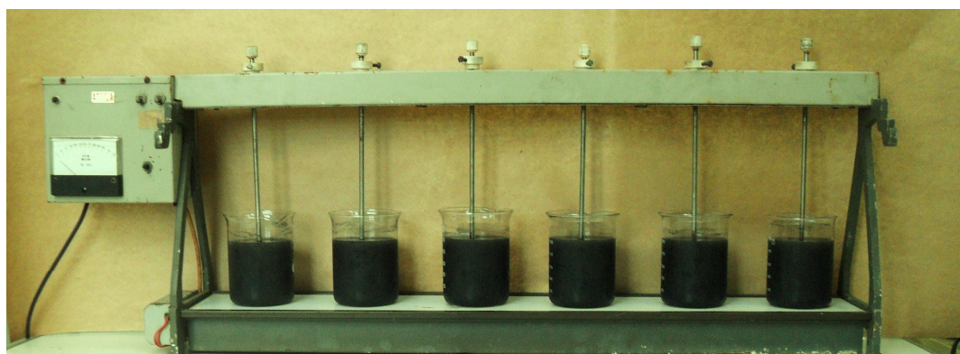
Figura 3.5: Equipamento jar-test simples, Milan – Modelo JT 101/6, utilizado durante a pesquisa.
