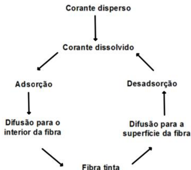
Figura 8 – Mecanismo do tingimento de poliéster.
