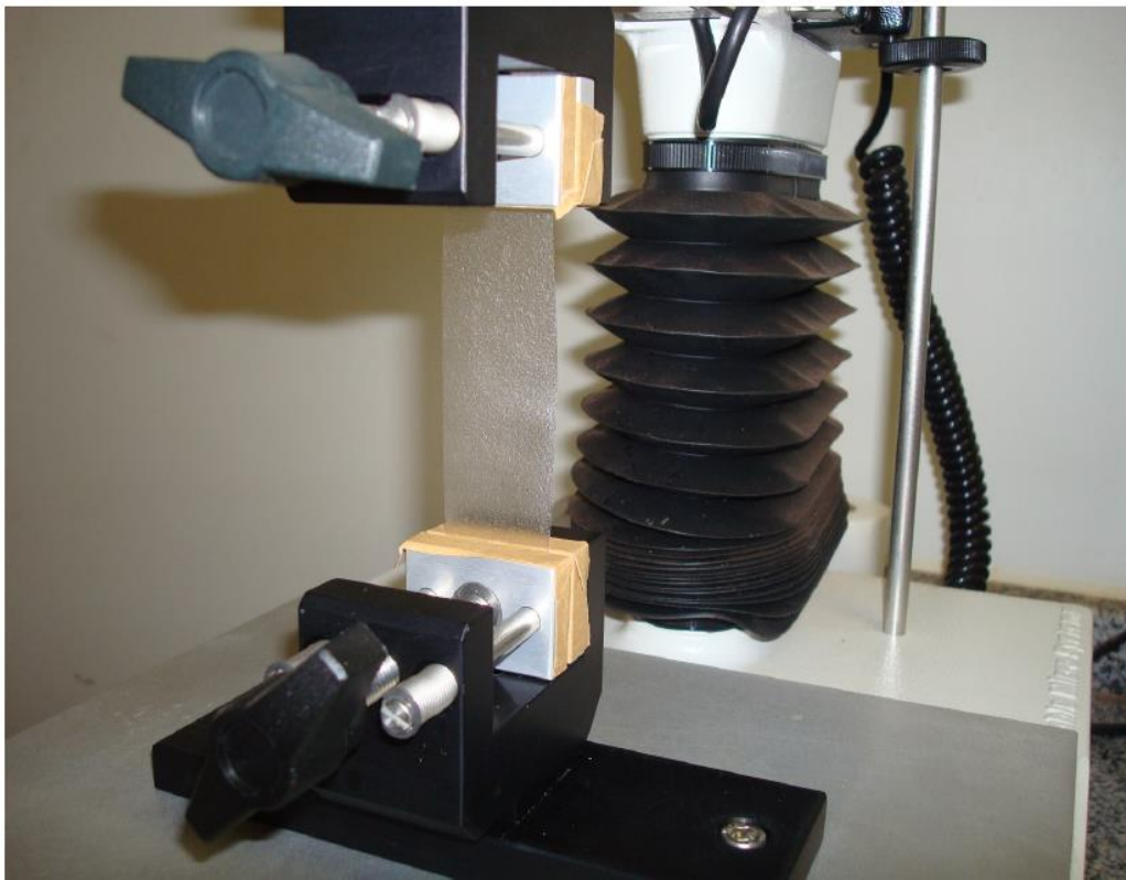
Figura 4.5: Texturômetro utilizado para realização dos ensaios das propriedades mecânicas.
