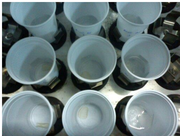
Figura 4.3: Amostras de filmes sob agitação durante a realização das análises de solubilidade em água.
