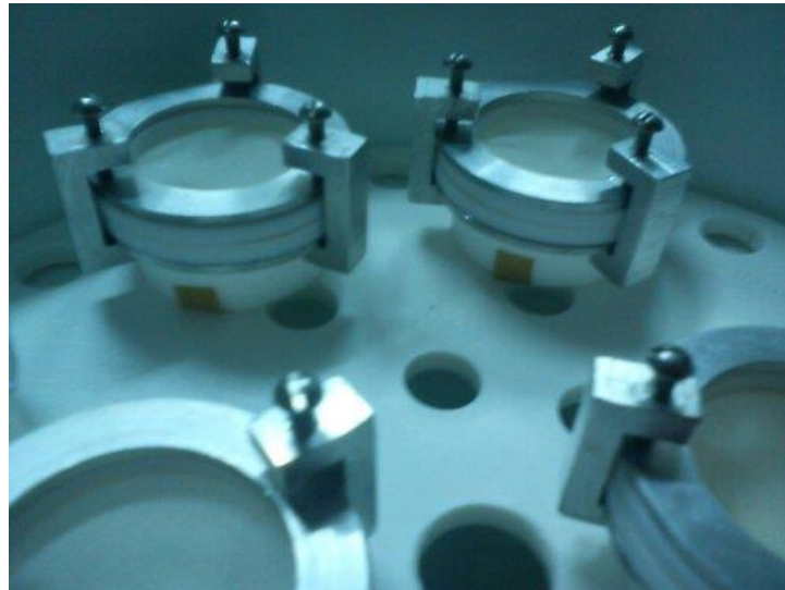
Figura 4.4: Células de teflon e alumínio utilizadas na análise de permeabilidade ao vapor de água.
