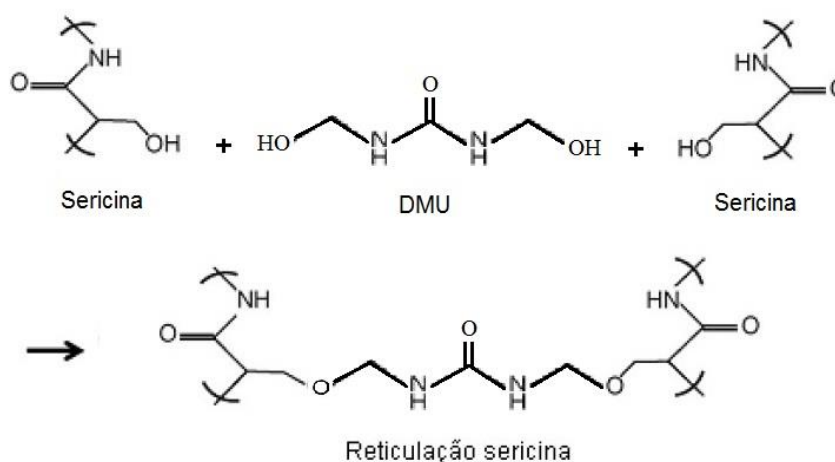
Figura 5.1: Esquemática da reticulação da sericina com DMU.
