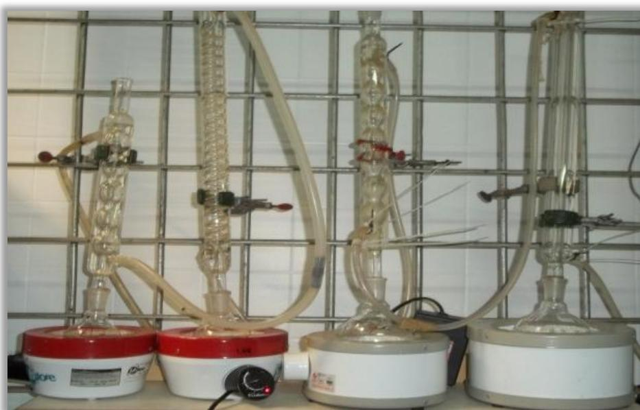
Figura 22 - Hidrólise ácida do meio após centrifugação e separação do sobrenadante para análise de ART (Fonte: Autor)
