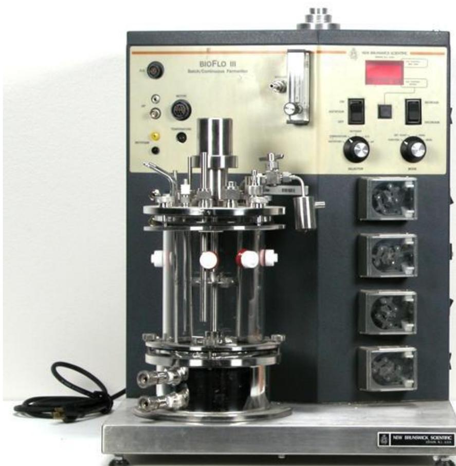
Figura 12 - Fermentador BioFlo III (Fonte: Artisan)
