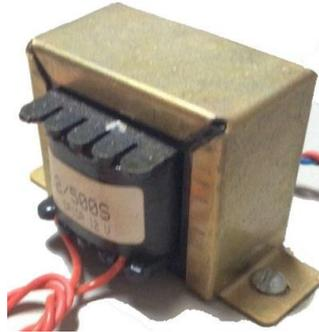
**Figura 2.17.** Representação fotográfica de um transformador pequeno.
