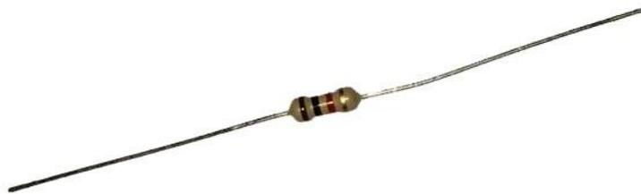
**Figura 1.5.** Imagem fotográfica de um tipo de resistor usado em circuitos.
