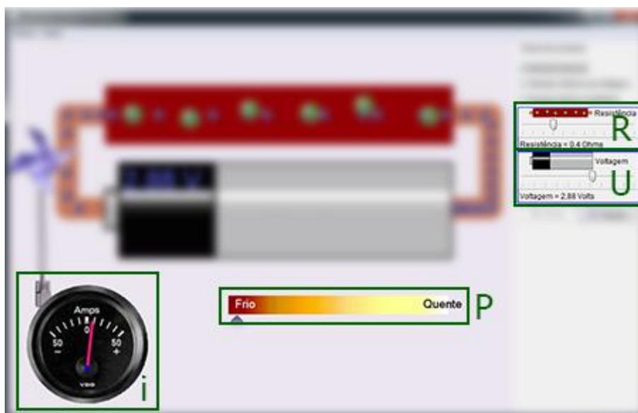
**Figura 2.3.** Alterando as variáveis no simulador, destacadas na figura. Nesse caso, a resistência está ajustada em  $0,4 \Omega$ , e a d.d.p. em  $2,88 \text{ V}$ . Fonte: *Print screen* do simulador.
