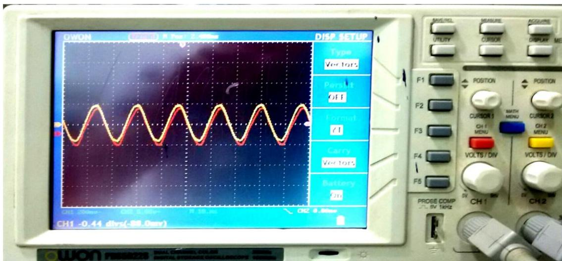
Figura 57 - Medição de Tensão (amarelo) e corrente (vermelho) do circuito com três capacitores ligados.
