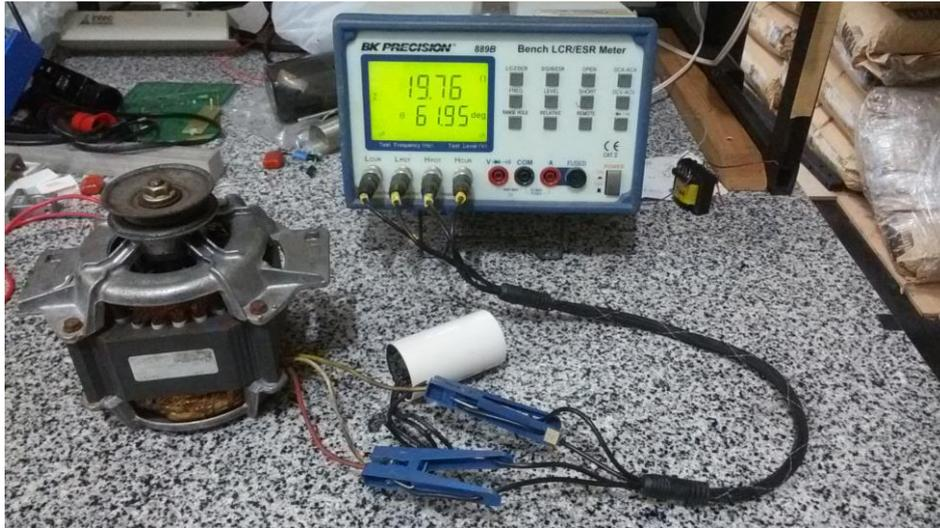
Figura 39 - Medidor de Impedância.
