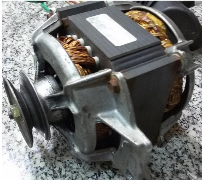
*Figura 38 - Motor Monofásico.*
