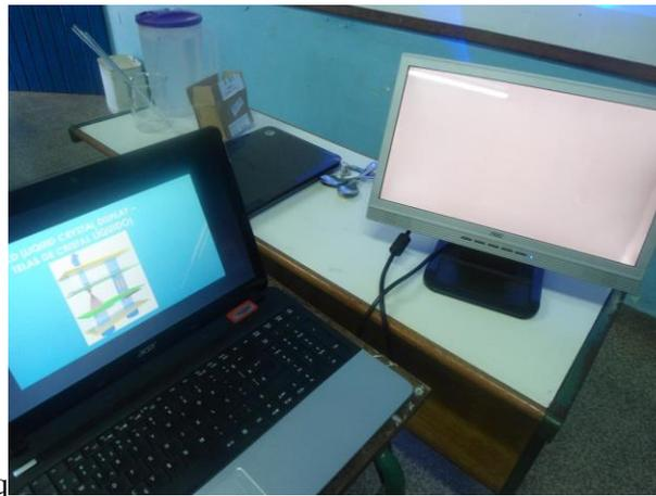
**Figura 4.10** - Monitor de Cristal Líquido (LCD) com polarizador de saída retirado.
