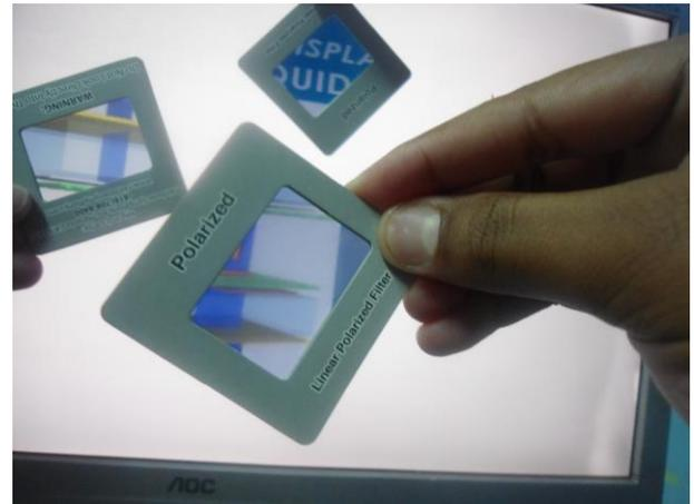
**Figura 12** - LCD sem polarizador observado através de polarizadores externos.
