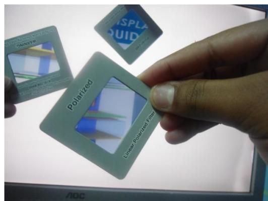
**Figura 4.12** - Visualização da imagem monitor LCD sem polarizador através de filtros polarizador. Fonte: autor.
