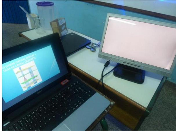
**Figura 3.10** - Monitor de Cristal Líquido (LCD) com polarizador de saída retirado.
