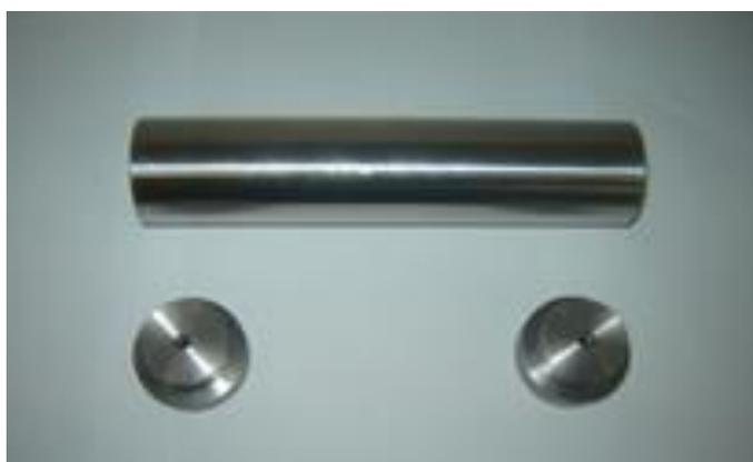
**Figura 8.** Foto ilustrativa do reator horizontal de aço inoxidável
