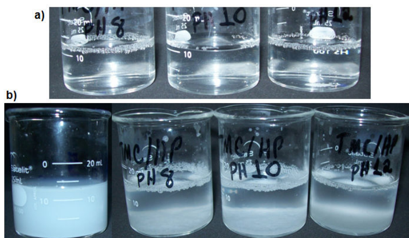
Figura 16. Soluções de TMC (pH 8, pH 10 e pH 12) antes da adição de heparina (16a), PEC2-5 (PEC em suspensão – esquerda obtido em pH 5), PEC2-8, PEC2-10 e PEC2-12 (direita) preparados em meio alcalino após 24 horas de obtenção (16b).
