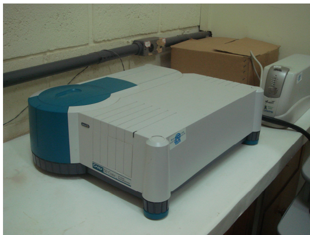
Figura 16 - Espectrofotômetro UV-Visible Cary 50 Conc com intervalo de leitura de 200 nm a 1100 nm.
