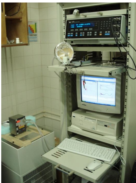
Figura 18 – Foto do analisador de impedância Solartron SI1260 acoplado a um computador - Laboratório de Cristais Líquidos – DFI.
