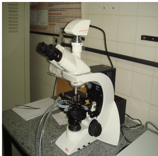
Figura 14 – Foto do microscópio DM - LP Leica com Câmera CCD – DXC – 107A Sony acoplada, e controlador de temperatura (Hotstage). Laboratório de Cristais Líquidos – DFI.
