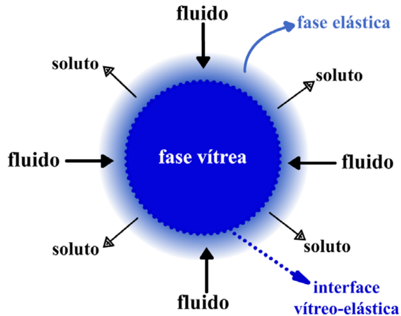
Figura 1.3 – Esquema das fases no hidrogel durante o processo de intumescimento. A região seca é denominada de fase vítrea, a região intumescida de fase elástica. Entre as fases encontra-se a interface vítreo-elástica.
