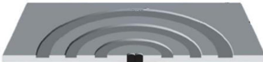
Figura 21 - Desenho mostrando a estrutura que será fabricada, onde anéis concêntricos circulam os dois buracos parcialmente sobrepostos (no centro).
