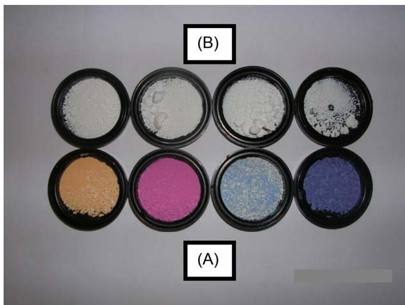
Figura 32: Perfil visual do TiO<sub>2</sub> filtrado após contato com os quatro corantes estudados: (A) após adsorção (20 min de sonicação) e (B) após 6h de fotodegradação.
