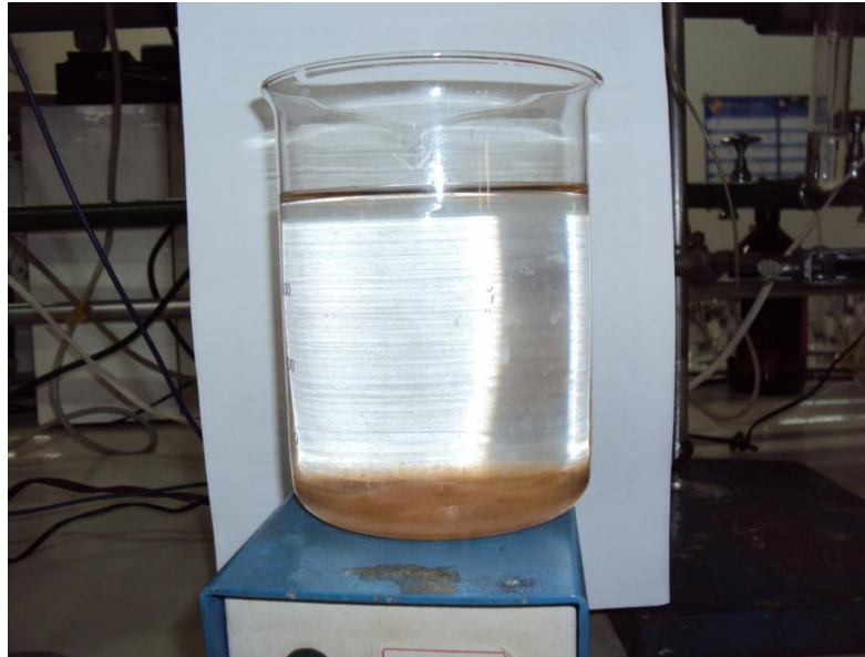
Figura 43. Amostra após procedimentos de floculação/sedimentação de amostra de água de rio.
