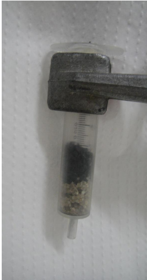
Figura 44. Filtro utilizado na etapa de filtração para limpeza física da água. Contendo: 1,10cm de carvão antracito, 0,85 cm de areia grossa e 0,85 cm de areia fina.
