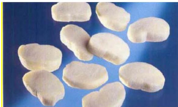
**Figura 1.2** – Policloropreno na forma “chips”
