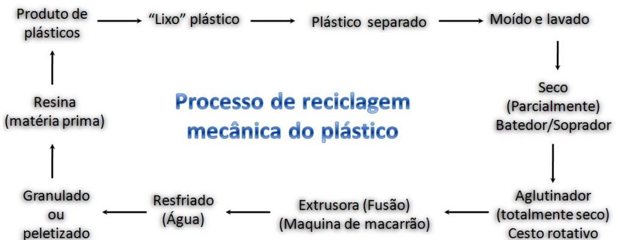
**Figura 1.9** – Diagrama esquemático para reciclagem mecânica de termoplásticos.
