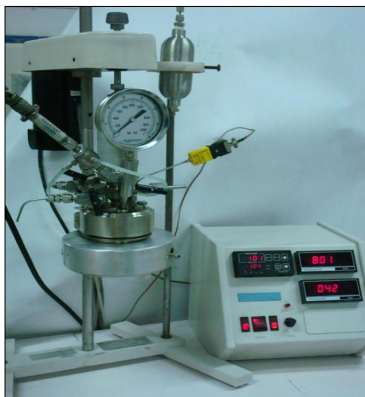
Figura 6 - Reator Parr mod. 4654 utilizado nas reações simultâneas de transesterificação e esterificação, disponível no LCHBio.
