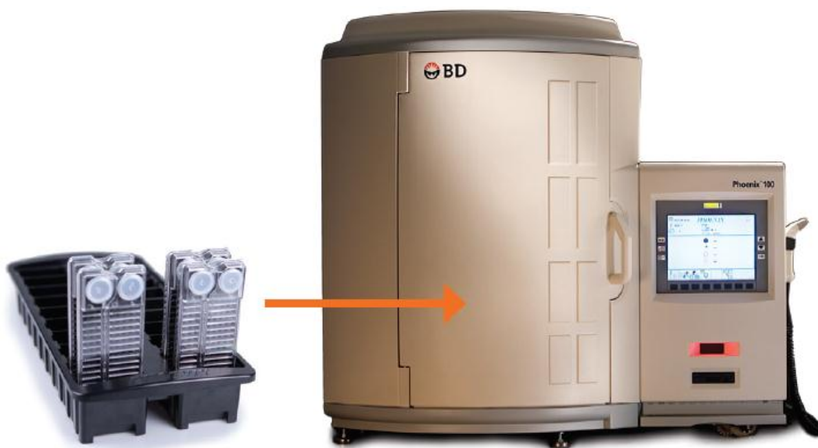
Figura 5 - Aparelho de identificação rápida de cepas bacterianas modelo Phoenix 100 (Becton Dickinson Diagnostics) e placas nas quais são adicionadas as amostras a serem analisadas.
