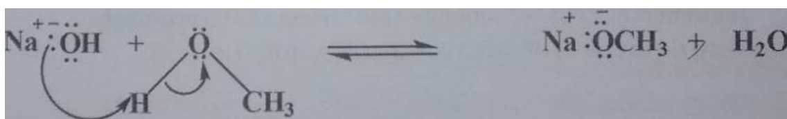
Figura 5 - Formação de metóxido de sódio a partir da reação entre o hidróxido de sódio e metanol. Fonte: Adaptado de Solomons (1998).
