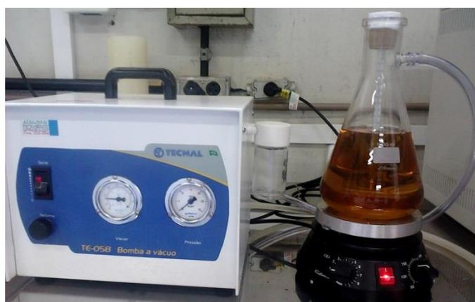
Figura 8- Sistema de secagem a vácuo.
