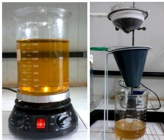
Figura 7-Aquecimento e filtragem do óleo de fritura.
