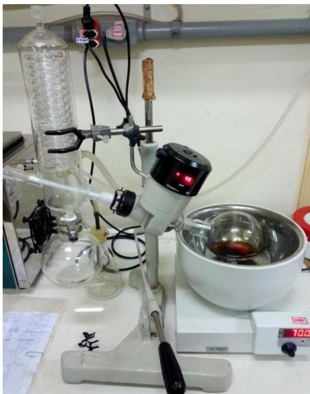
Figura 16- Recuperação do etanol.
