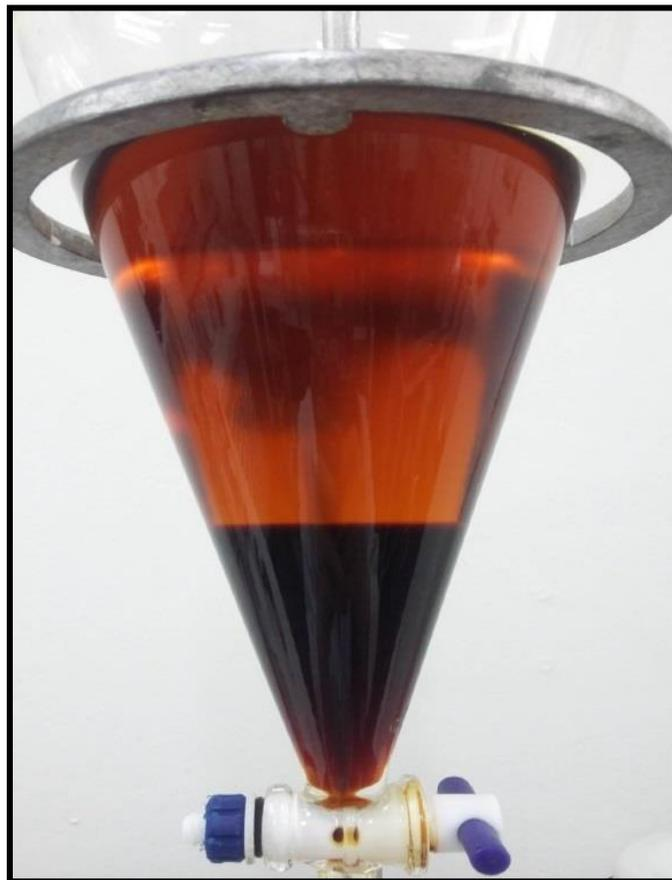
**Figura 7** - Separação de fases no funil de decantação (ésteres na parte superior e glicerol na parte inferior).
