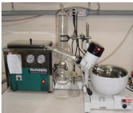
**Figura 11** - Rota evaporador equipada em uma bomba hidro vácuo
