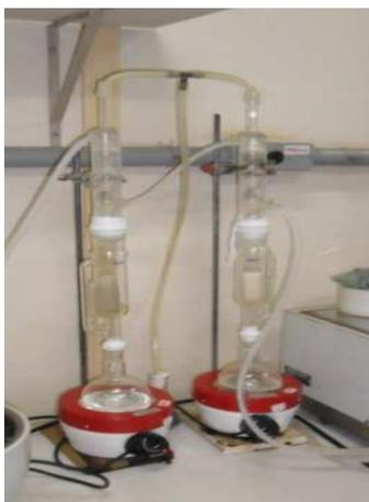
Figura 7 - Sistema de refluxo Soxhlet
