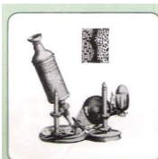
■ Microscópio de Robert Hooke. Afbeelding uit Hooke's Micrographia, London, 1664. Fonte: Deutsches Museum.
