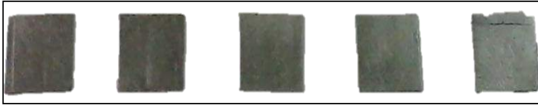
Figura 28 Amostras cortadas em quadrados de 1,5 x 1,5 cm.
