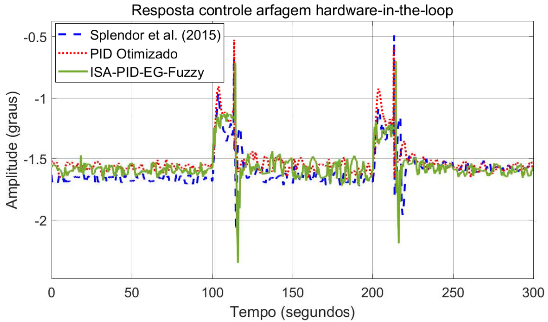
Figura 5.17: Comparação da resposta na simulação 2 da malha de controle do ângulo de arfagem com controlador ISA-PID-EG-Fuzzy na plataforma HIL.
