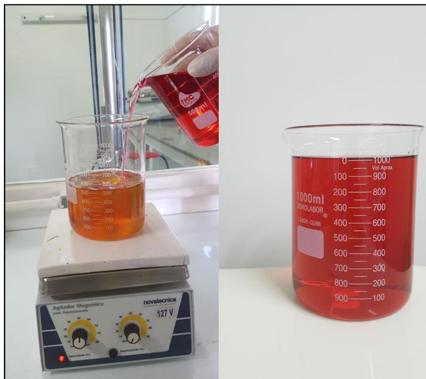
Figura 4 – Mistura de 50% diesel S500, 30% de etanol anidro e 20% de bioaditivo cossolvente comercial com aspecto límpido e homogêneo durante um ano.
