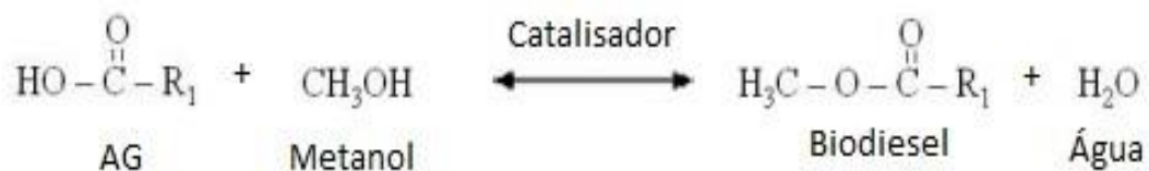
Figura 7. Reação de esterificação (adaptado de ENCARNAÇÃO, 2008).
