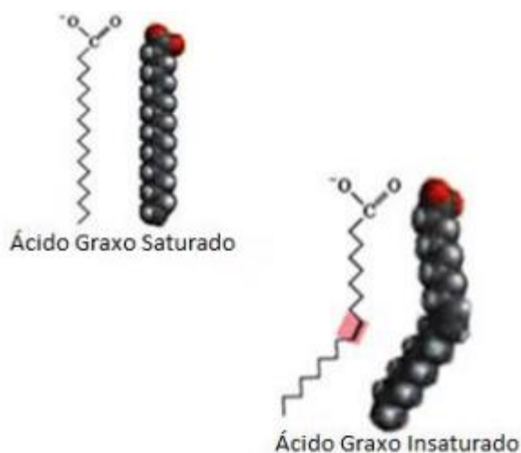
Figura 2. Modelos de moléculas de ácidos graxos saturado e insaturado (Fonte: Voet e Voet (2006)).
