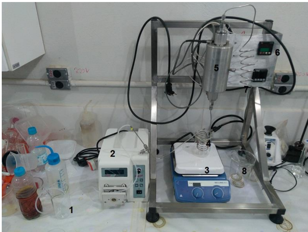
Figura 11. Diagrama esquemático do aparato experimental. (1) Solução contendo a mistura de óleo de macaúba e metanol; (2) Bomba peristáltica que controla a vazão de bombeamento da mistura para o reator; (3) Placa de aquecimento para o béquer contendo água; (4) Pré-aquecimento antes da entrada no reator; (5) No exterior, o forno de aquecimento com controle de temperatura; no interior, o reator contendo as esferas de vidro e o catalisador em leito empacotado; (6) Controlador de temperatura para o forno de aquecimento do reator; (7) Zona de resfriamento para a mistura que sai do reator com alta temperatura; (8) Coleta de amostra da mistura reagida no interior do reator pela presença do catalisador (Fonte: acervo próprio).
