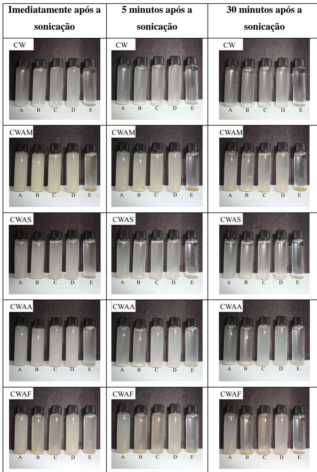
**Figura 1.27.** Fotografias representativas das suspensões resultantes após sonicação dos nanocristais e nanocristais modificados em diferentes solventes, (A) água, (B) etanol, (C) acetona, (D) acetato de etila e (E) tolueno.
