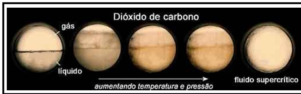
Figura 1.4. Mudança de estado líquido/gás do dióxido de carbono ( \text{CO}_2 ) para estado supercrítico FONTE: Karen Miller e Tony Phillips da NASA (Phillips, 2003).
