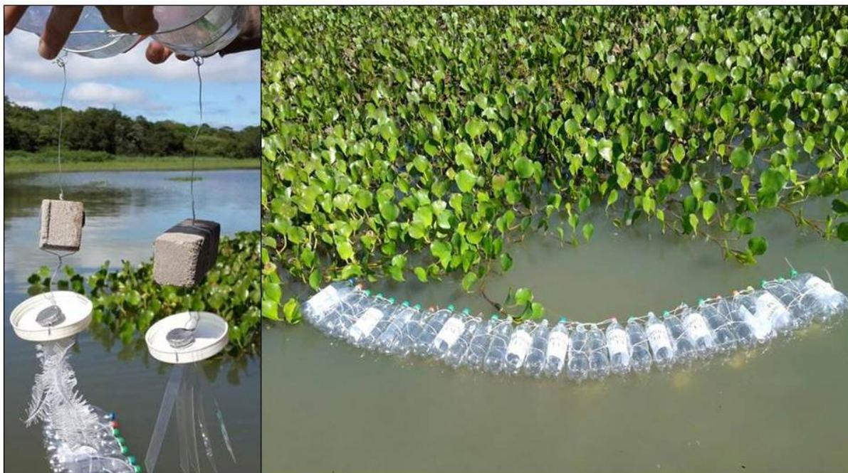
**Figura 3:** Macrófitas artificiais confeccionadas e disposição dos substratos no ambiente de colonização das algas perifíticas.
