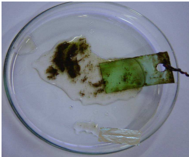
Figura 4: Remoção da comunidade perifítica dos substratos, com auxílio de lâmina de barbear envolta em papel alumínio.
