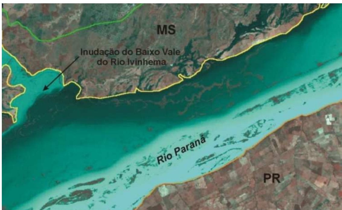
Figura 2. Macrossistema fluvial do alto Paraná. A linha amarela delimita a área inundada por transbordamento do rio Paraná. A linha verde delimita a área inundada pelo elevamento do lençol freático. Composição falsa cor Landsat 5 TM, R5 G7 B3 17/01/1990. Nível hidrométrico: 7.90 m. Vazão: 26825 m 3 /s na estação de Porto São Jose. Tomado de Meurer (2004).
