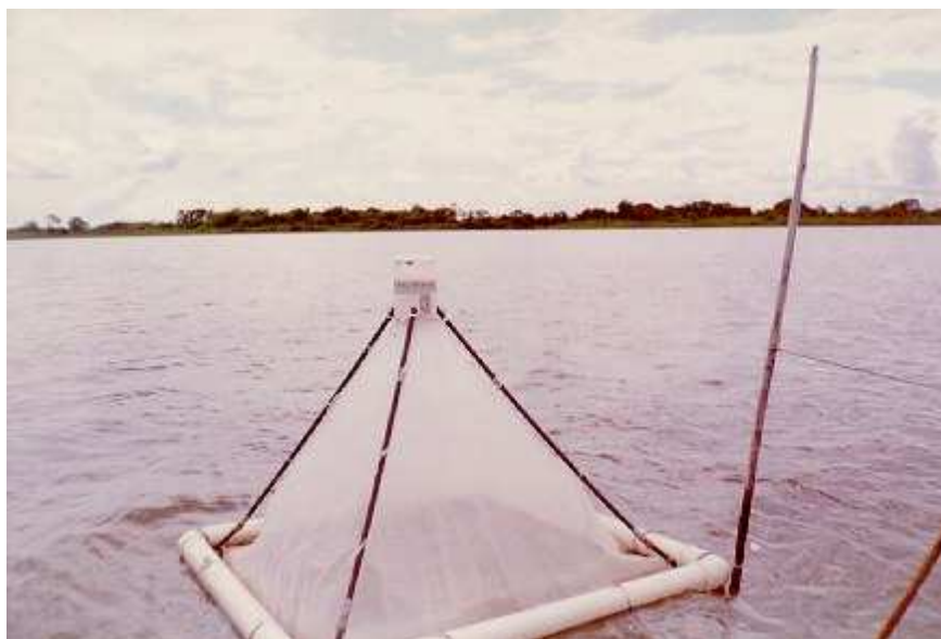
Figura 2: Modelo de armadilha de emergência flutuante para a captura dos insetos adultos.
