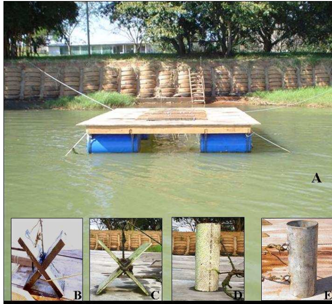
Fig. 3 – Experimento com substratos artificiais, localizado no rio Paraná, município de Porto Rico (PR). A) Plataforma flutuante; B) madeira em forma de X (MADX); C) nitacetal em forma de X (NITX); D) PVC em forma de tubo (PVCT); E) metal em forma de tubo (METT).
