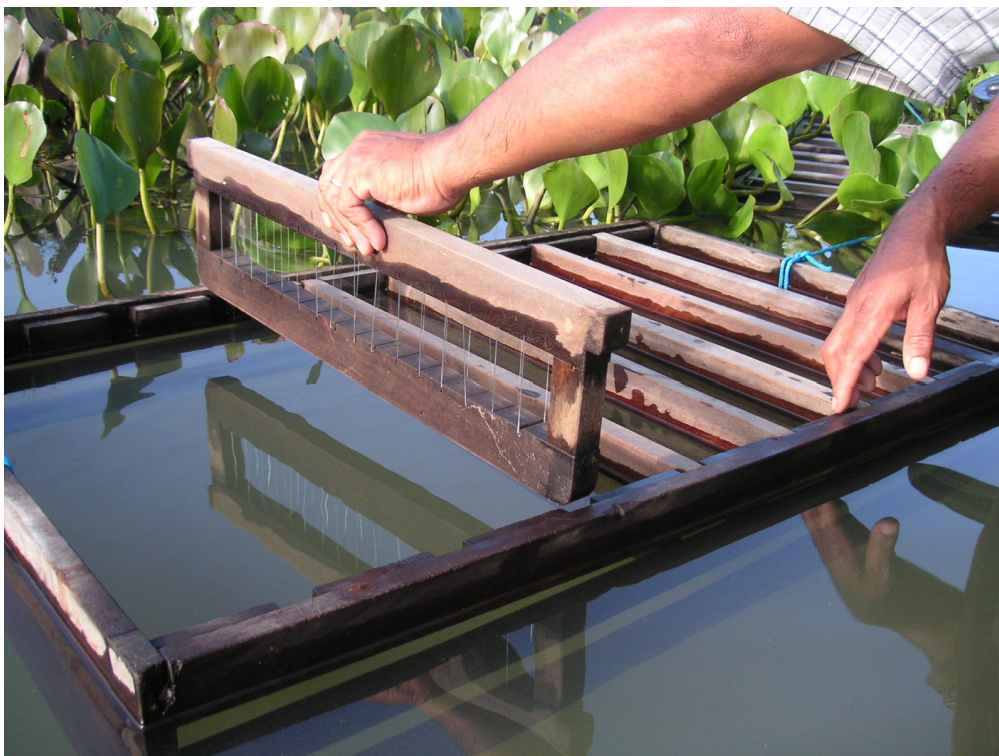
Figura 2. Lâminas de vidro, como substratos artificiais para o perífíton, em suporte de madeira.
