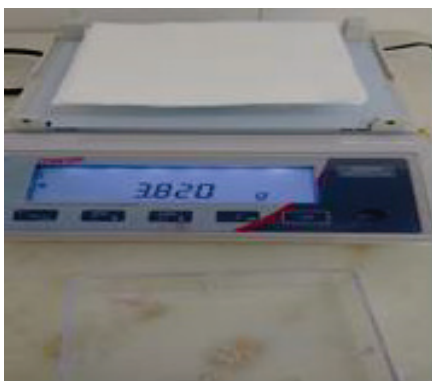
Figura 1 - Pesagem do substrato de papel na balança marte semi-analítica modelo AD.
