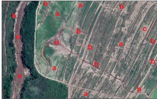
Figura 42 – Processos erosivos em área rural: a. sulcos; b. ravinas; c. erosão laminar; d. leque de deposição; e. assoreamento.
