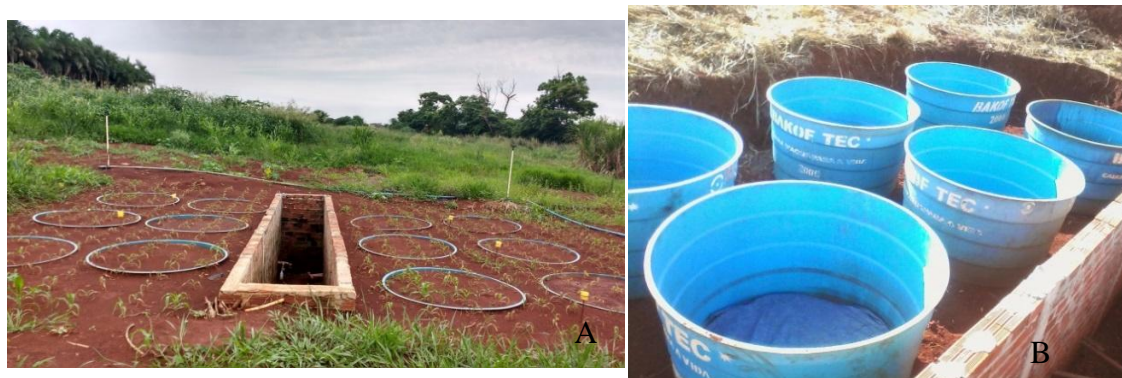
Figura 2. Área experimental com os 12 lisímetros e o fosso de coleta (a); e implantação dos lisímetros no campo (b)
